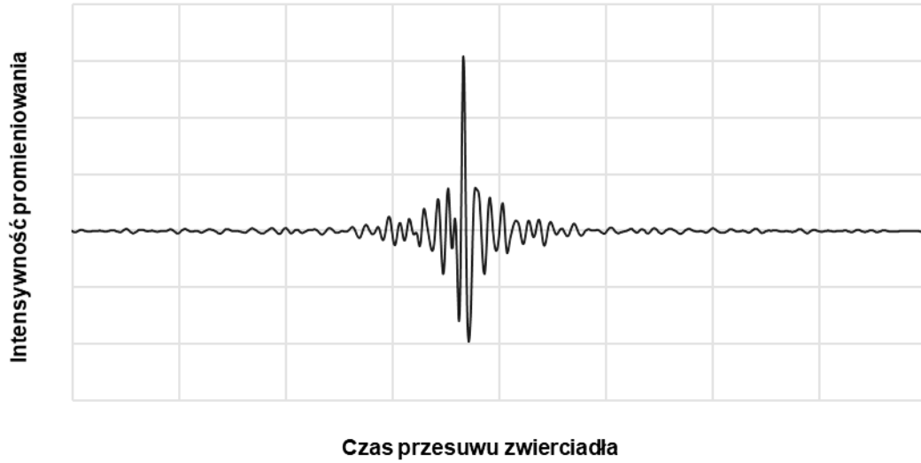
Rys.5 Interferogram przedstawiający zależność intensywności promieniowania od czasu przesuwu zwierciadła.
